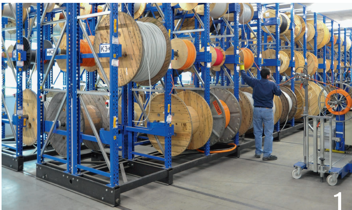
1 Kabeltrommel-Abspulregale auf elektrisch angetriebenen Verschiebewagen
