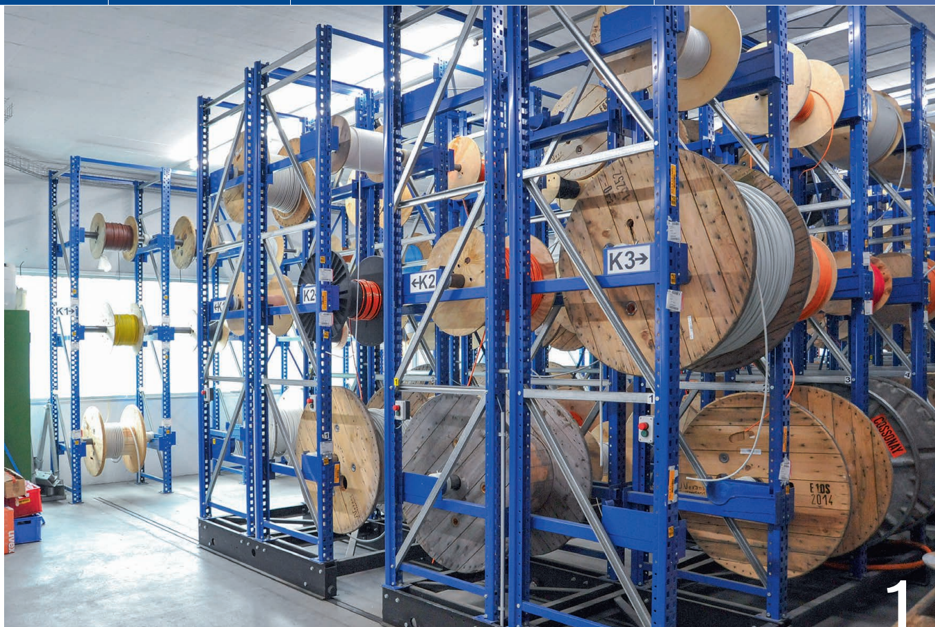
1 Kabeltrommel-Abspulregale auf elektrisch angetriebenen Verschiebewagen
