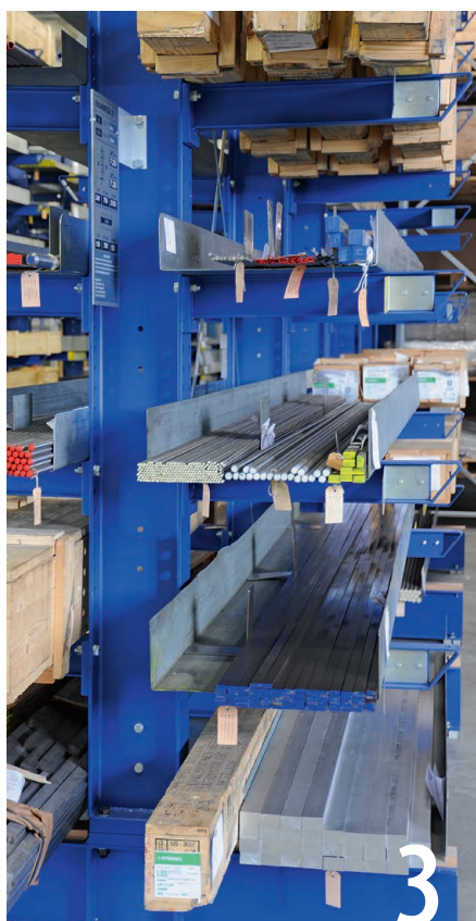
1 + 2 Das Achsmass der Regalständer ist auf die Länge und die Beschaffenheit des Lagergutes abgestimmt. 3 Lagerebene mit Blechkanal zur Lagerung von mehreren Qualitäten von Stabmaterial
