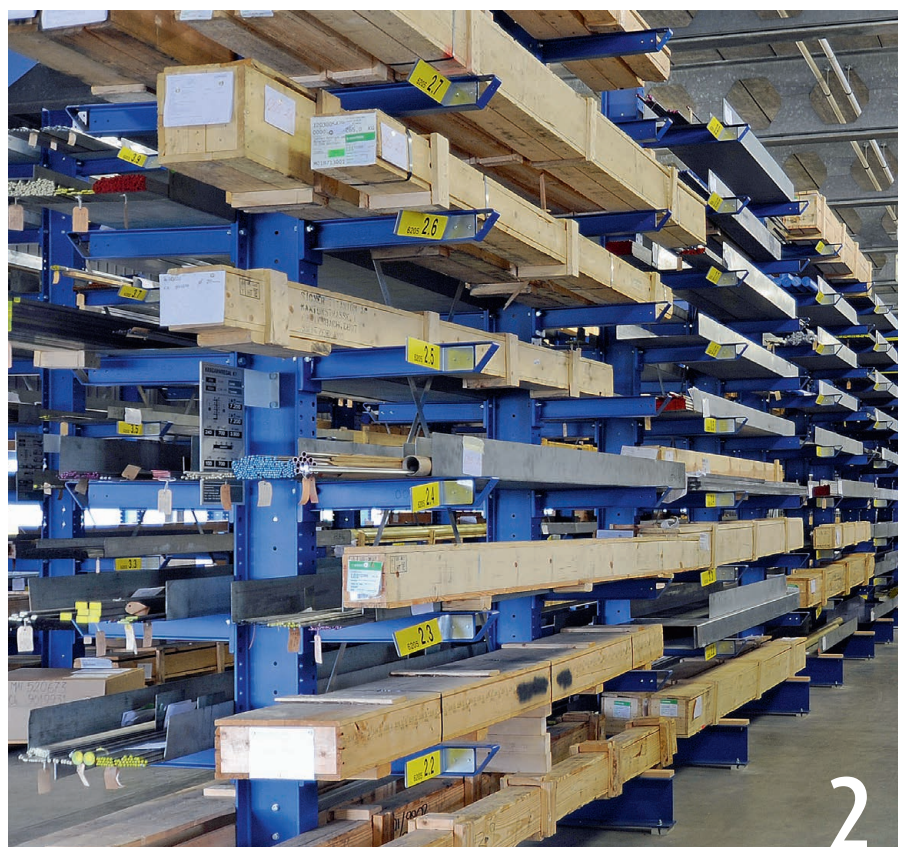
1 + 2 Das Achsmass der Regalständer ist auf die Länge und die Beschaffenheit des Lagergutes abgestimmt. 3 Lagerebene mit Blechkanal zur Lagerung von mehreren Qualitäten von Stabmaterial
