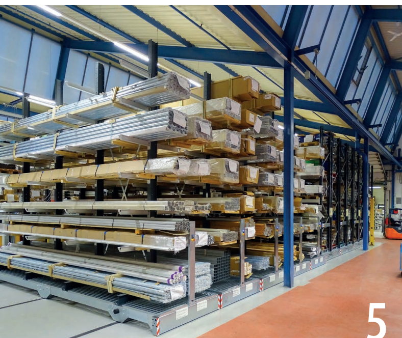
3 – 4 Kragarmregal IPE in Kombination mit Komponenten vom Universal-Steckregal. 5 Kragarmregal auf elektrisch verschiebbaren Wagen
