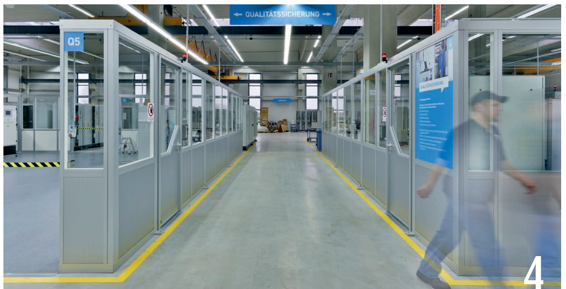
2 – 4 Freistehende Trennwände K60 zur Abtrennung von Arbeits- und Aufenthaltsbereichen, als Vollwand oder mit Teilverglasung.
